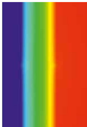
Schöck Thermoanker \lambda = 0,7 \text{ W}/(\text{m}\cdot\text{K})
